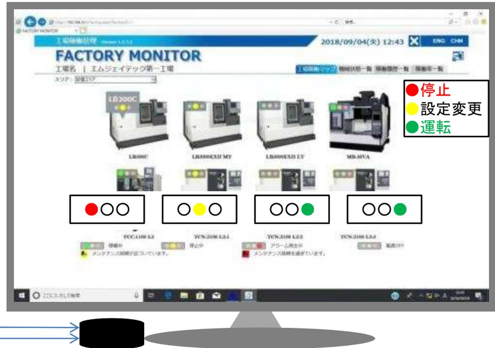
稼働モニタリングソフトの画面 接続されている工作機と状態が表示(イメージ)
